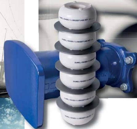
Puffer mit DUREL-Polymerfedern dienen als maximaler Schutz gegen Auflaufschäden für das rollende Material und sorgen für optimales zugdynamisches Verhalten. Eingebaut in Seiten- oder Mittelpuffer unterstützen DUREL-Pufferfedern dies durch ihre progressive Kennlinie. Mit ihrer einzigartigen Dämpfungseigenschaft von über 50 % der Stoßenergie steigern DUREL-Polymerfedern für Puffer den Fahrkomfort und die Sicherheit von Güterwagen, Lokomotiven, Reisezugwagen und Sonderfahrzeugen.
