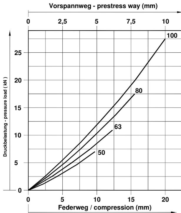
Durel - Getriebepuffer wurden für die federnde Abstützung von Drehmomenten (z.B. an Aufsteckgetrieben) entwickelt.
